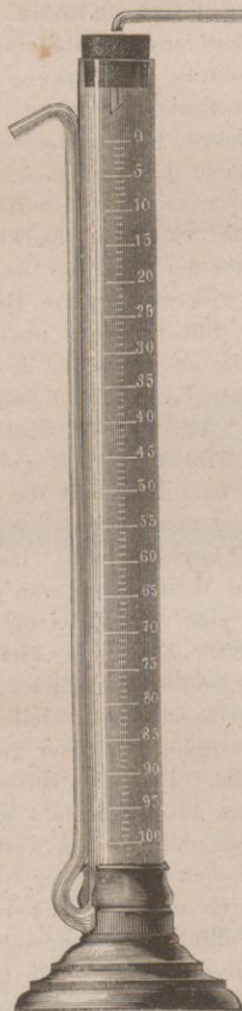
Gay-Lussac's Bürette mit Fuss und Blaserohr.
