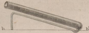
Neigung der Büretten beim Entleeren.
