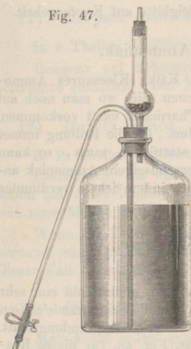
Aufbewahrungsgefäß für Aetzkali und Aetznatron mit Ausflussheber.
