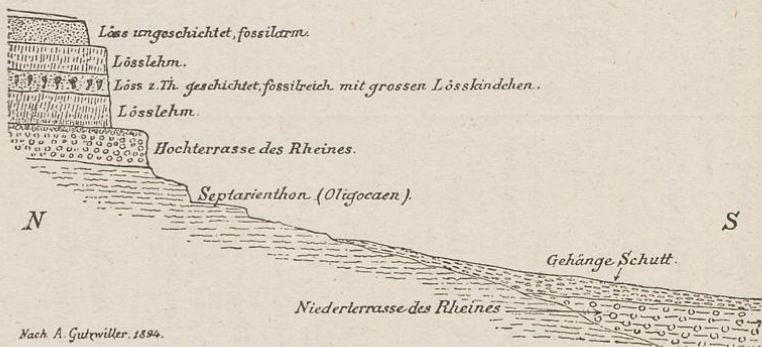
Cl. 9. — Profil der Lehmgrube Ziegelei von Allschwyl. — 1 : 1000.
