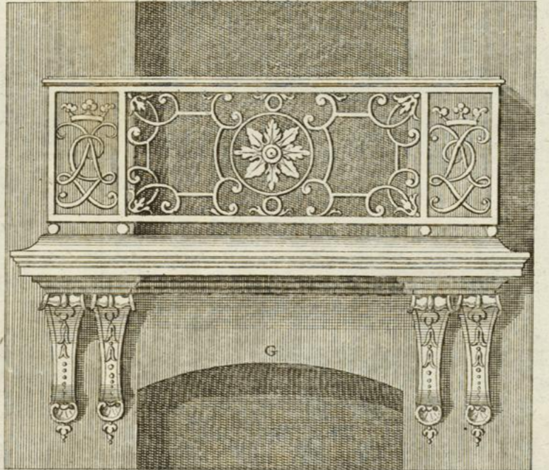
Balçon en tour ronde par le devant avec appui de fer soutenu par une Trompe droite propre pour le milieu ou l'extrémité d'un Batim.
