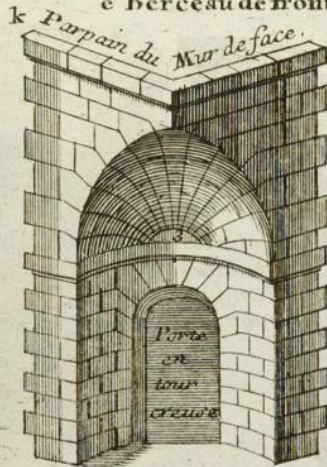
m Trompe sur le coin en coquille.
