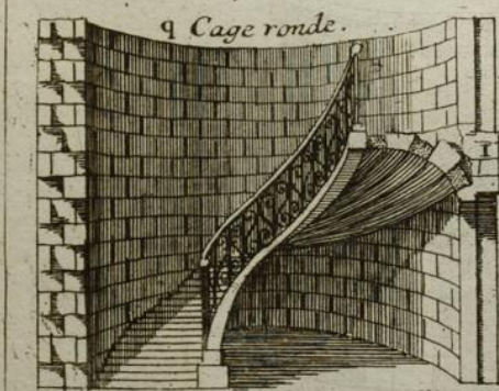
p Escalier a jour ou Vis suspendue.
