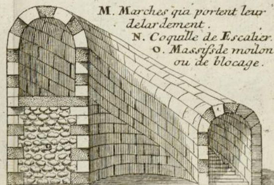
t. Berceau rompan et tournant.
