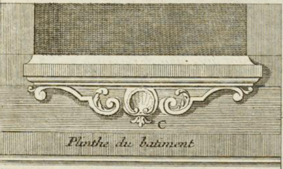
Banquette ou Tablette d'appui en Saillie avec arriere corps et ornement par le dessous.
