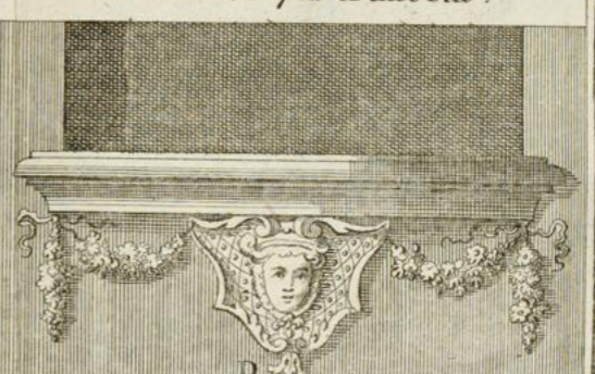
Banquette ou Tablette d'appui en tour ronde avec ornement par le dessous.
