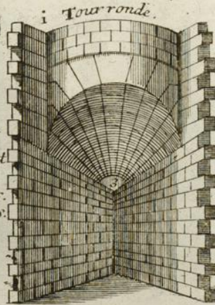
1. Trompe dans l'angle en Tour ronde et réglé.
