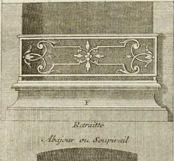
Banquette d'appui en Saillie avec ornemens par le dessous pour un premier étage.
